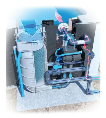
La filtration NFX, nouvelle génération brevetée, possède une finesse de filtration de 15 microns qui limite l'utilisation de produits chimiques avec une eau filtrée et renouvelée jusqu'à 3 fois plus rapidement. Plus écologique, la filtration à cartouche en circuit fermé évite le rejet d'eau dans les nappes phréatiques ou à l'égout. Plus simple d'utilisation, l'entretien se fait par simple lavage de la cartouche. Le skimmer est proposé en 5 coloris au choix. **Piscine Magiline**
